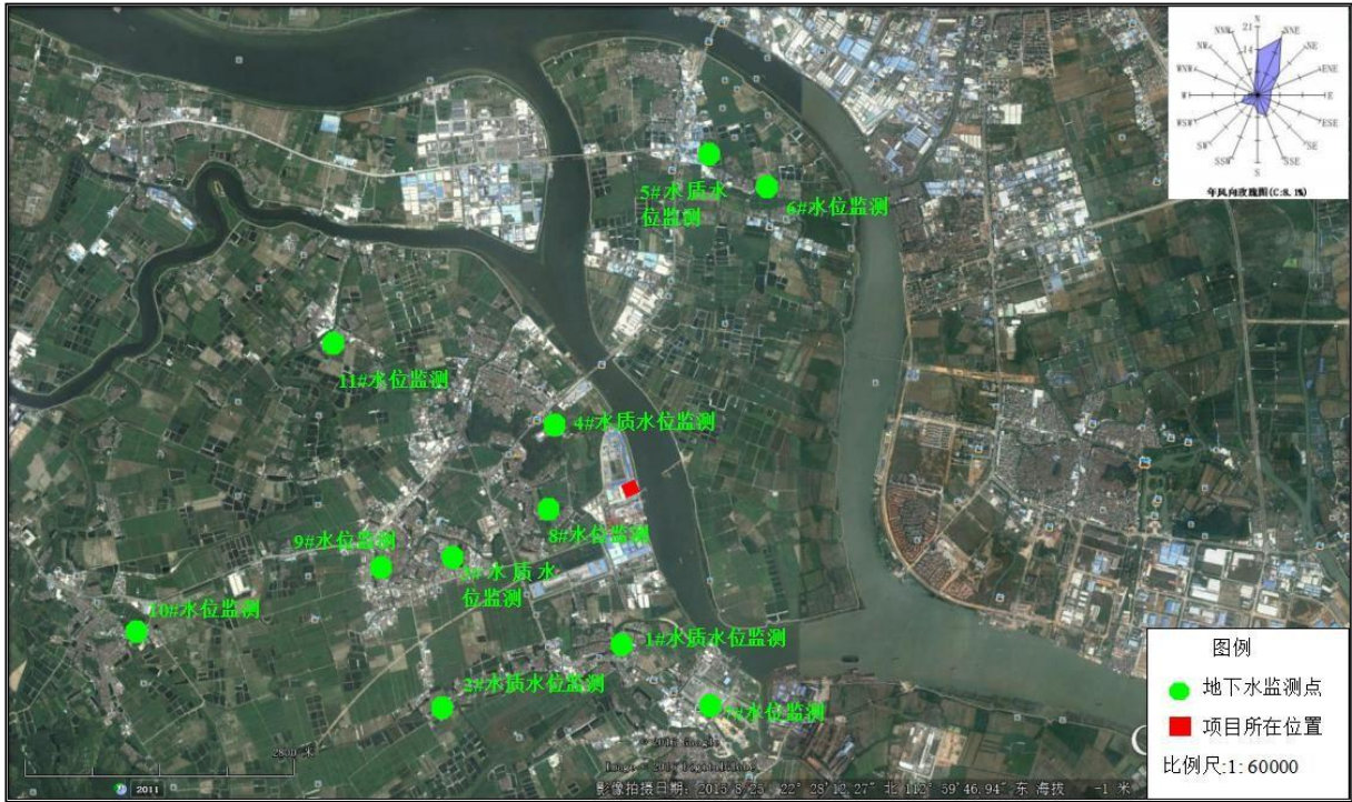
图5.4-1地下水监测点布置图
