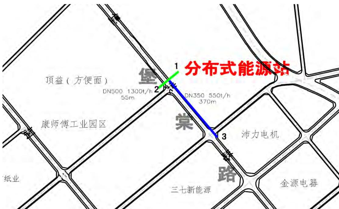
图 27 江沙片区冷冻水网走向图
