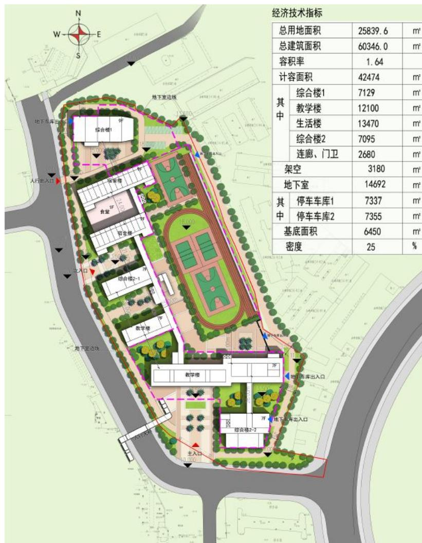
图 5-1 项目总平面布置图
