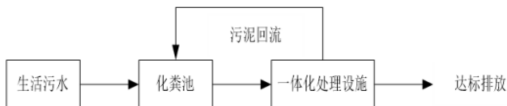
图 4-1 一体化污水处理设施工艺流程图
