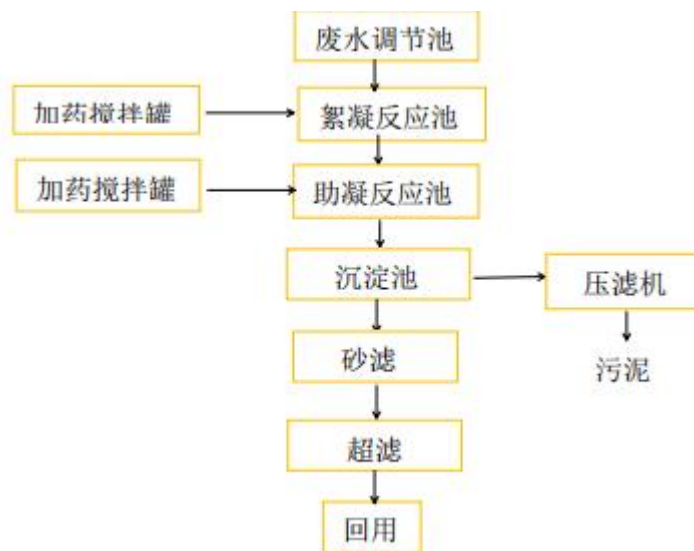
图 4-2 生产废水处理工艺流程图
