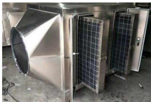
图 4-1 活性炭内部结构示意图
