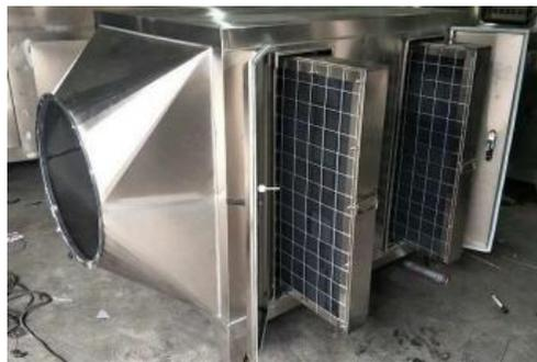
图 4-1 活性炭内部结构示意图
