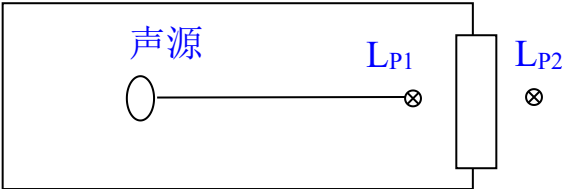
图 B.1 室内声源等效为室外声源图例
