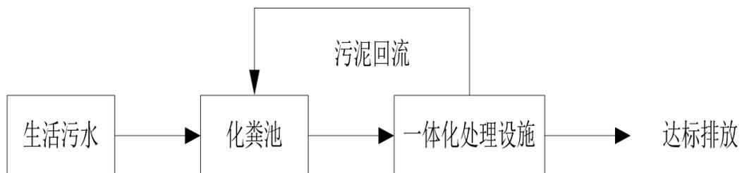
图4. 项目生活污水处理工艺流程图
