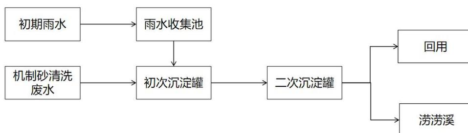
图 6.1-2 机制砂清洗废水处理工艺流程图
