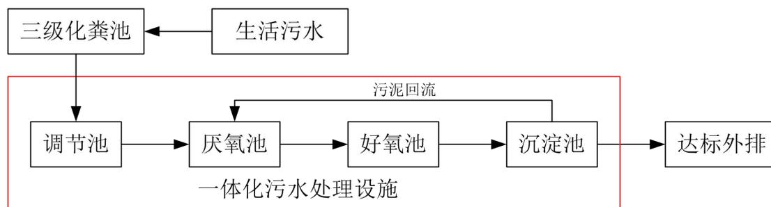
图 6.1-1 生活污水处理工艺流程图
