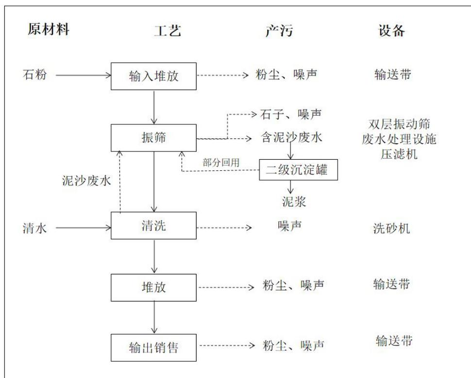
图 2-2 机制砂生产工艺流程图
