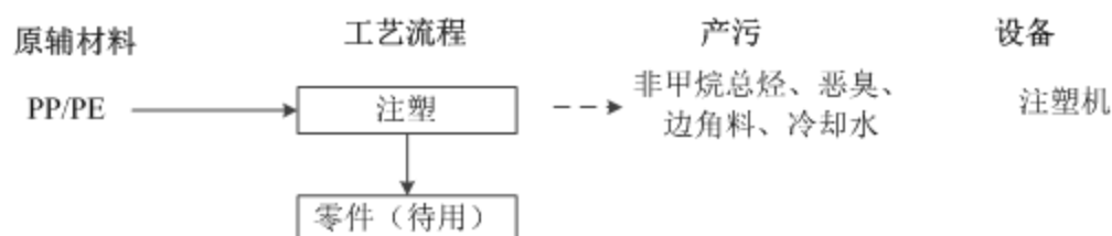
图2-3 塑料配件生产工艺流程图
