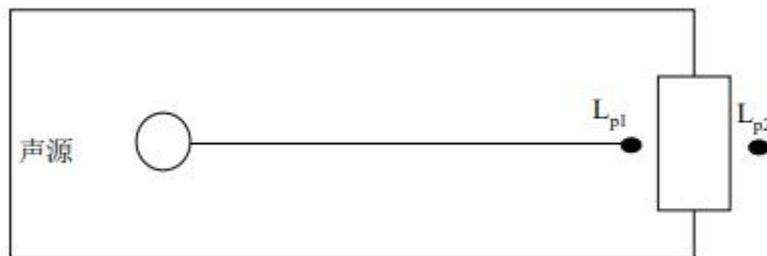
图 4-7 室内声源等效为室外声源图例
