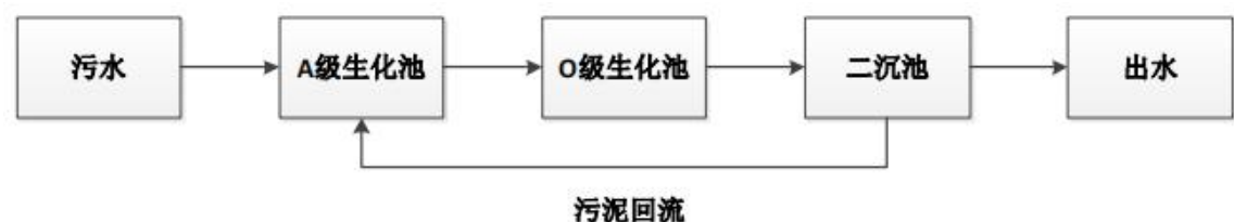
图 4-1 一体化污水处理设备工艺流程图
