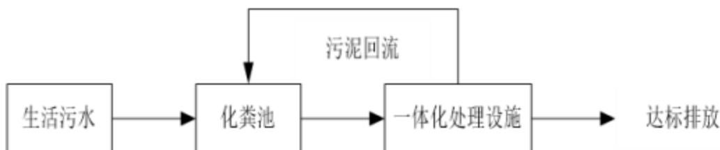
图 4-1 一体化污水处理设施工艺流程图
