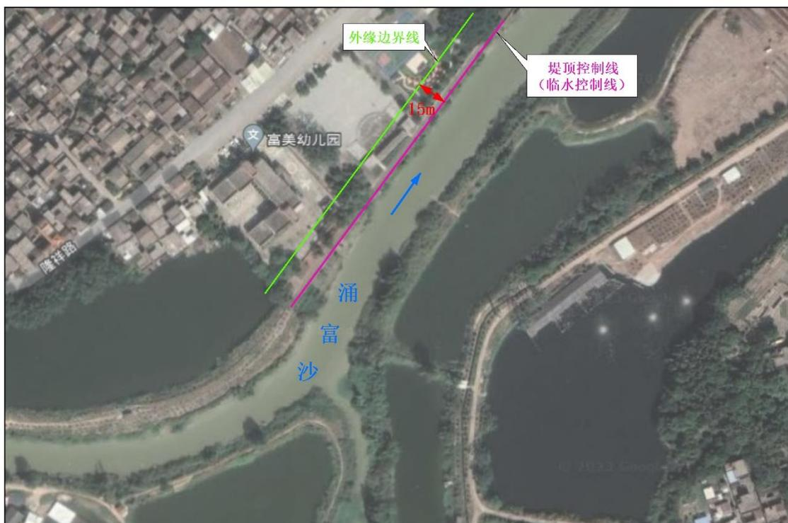
图 8.2-5 沙富冲堤防无明显背水坡河段岸线划定示意图 (3)
