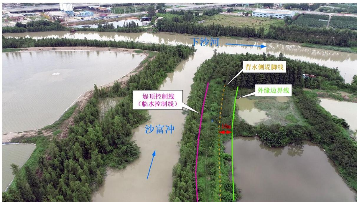
图 8.2-2 沙富冲堤防有明显背水坡堤脚河段岸线划定示意图 (2)
