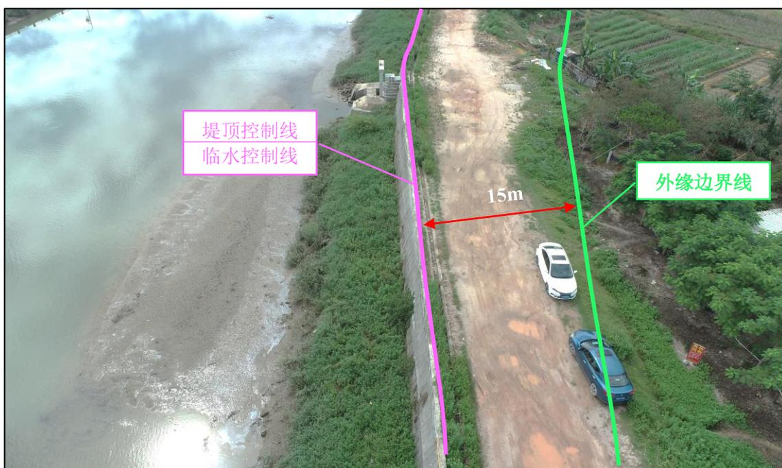
图 8.2-4 直墙式堤防河段岸线划定示意图 2
