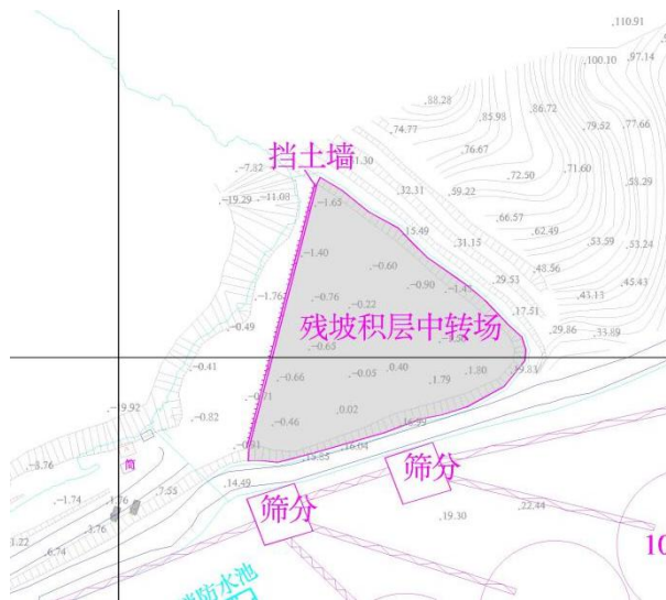
图 5-5 残坡积层中转场拦渣坝工程布置图
