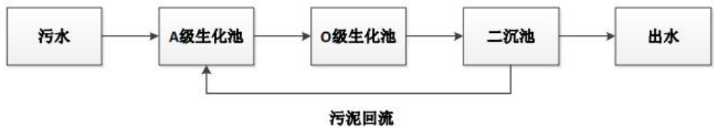
图 4-1 一体化污水处理设备工艺流程图
