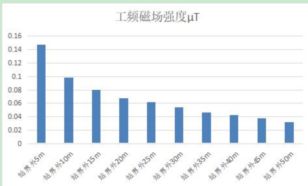
图3 工频磁场强度衰减示意图
