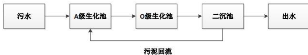
图 4-1 一体化污水处理设备工艺流程图
