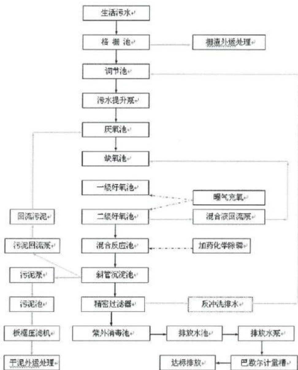
图 7. 新会区三江镇污水处理厂处理工艺流程图
