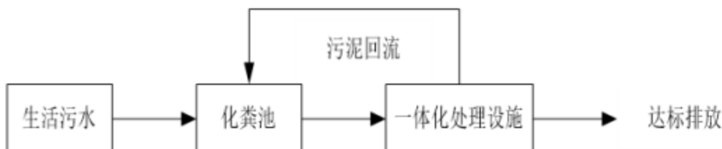
图 4-1 一体化污水处理设施工艺流程图
