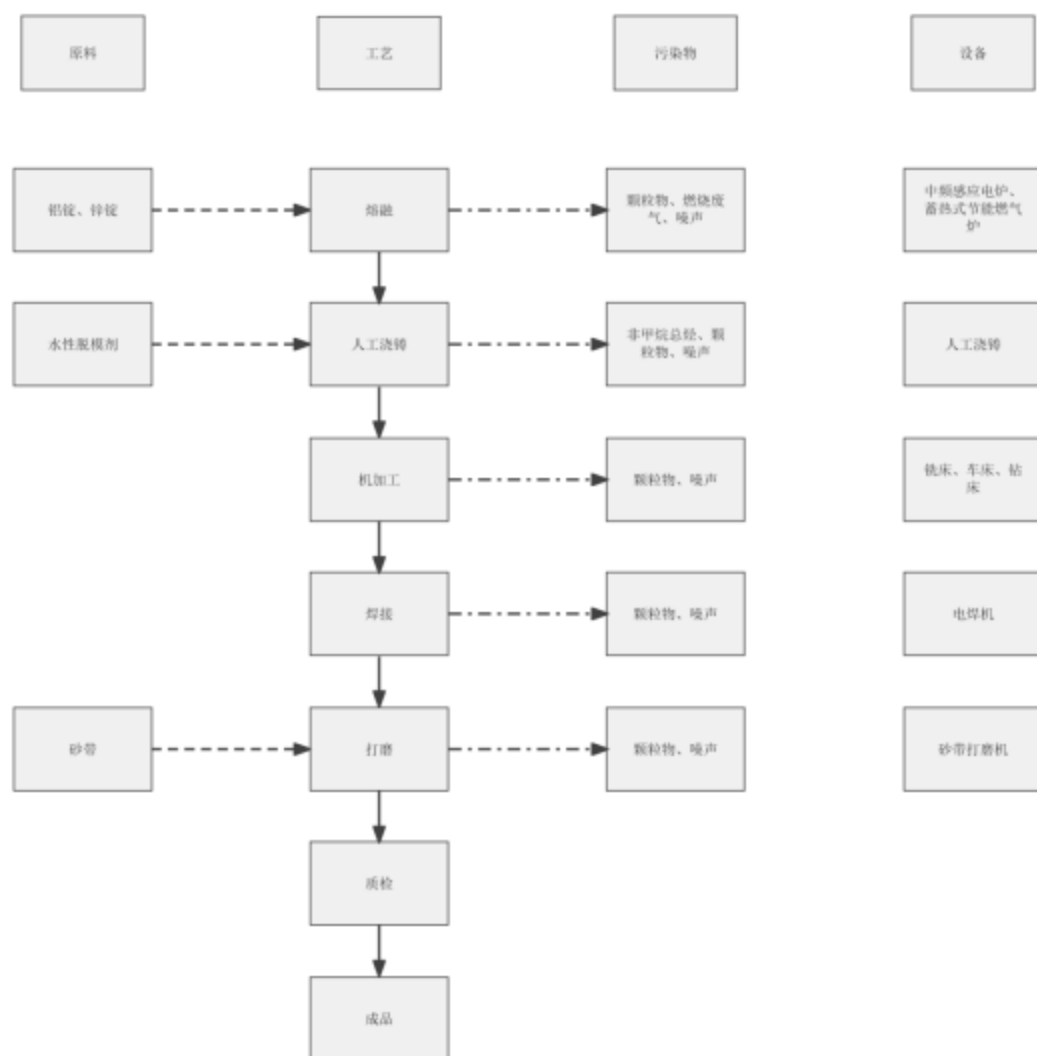
图 2-2 灯饰配件生产工艺流程
