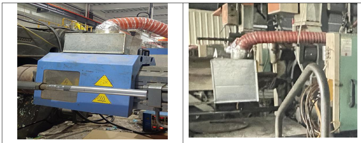
图 4-1 项目注塑废气收集示意图
