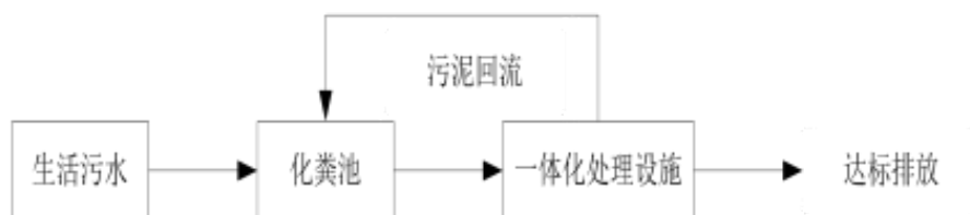
图 4-2 项目生活污水处理工艺流程图
