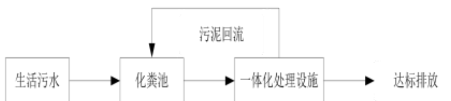
图 42 项目生活污水处理工艺流程图
