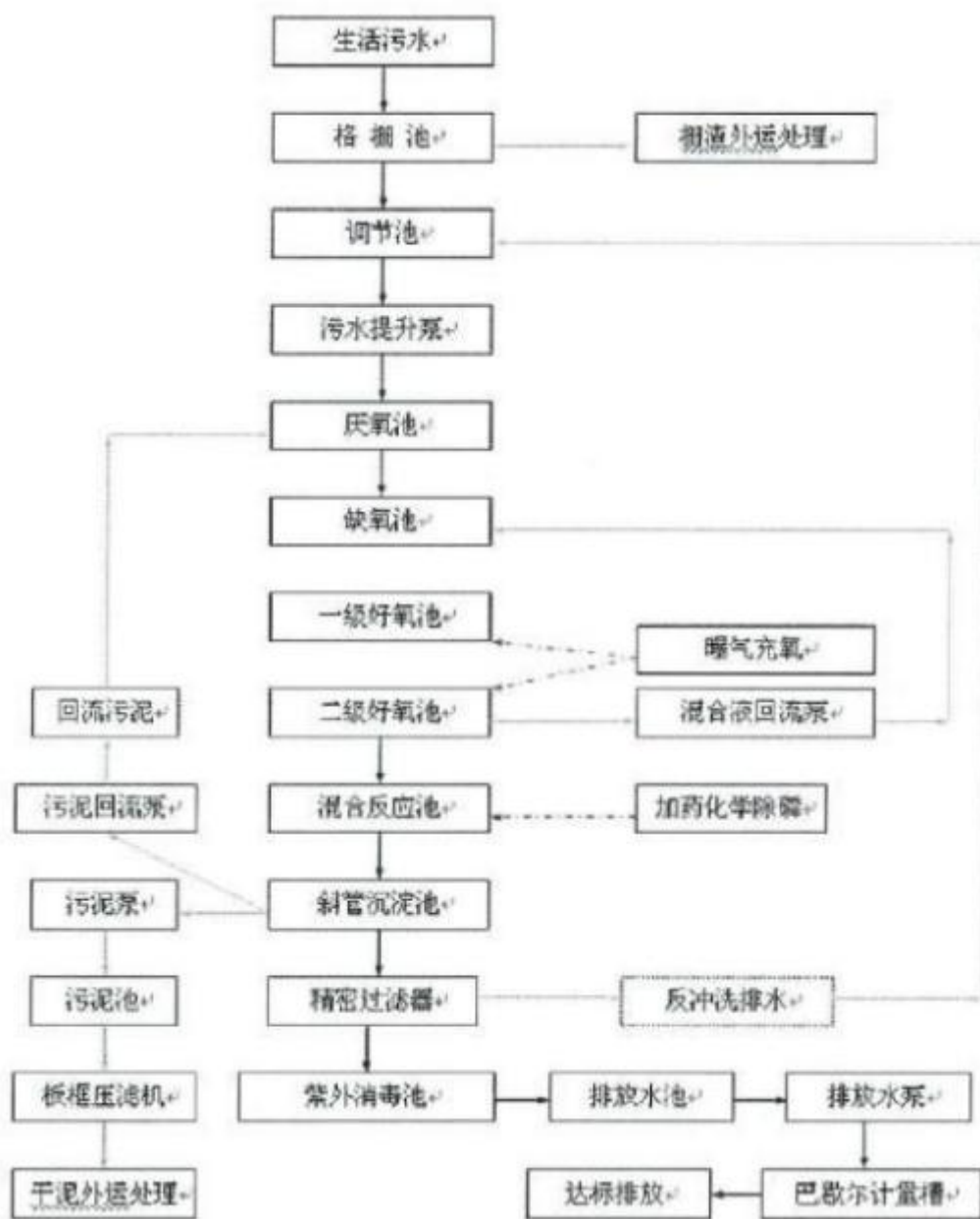
图 4-2 三江镇污水处理厂工艺流程图
