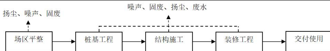
图2-2 项目施工期工序及产污节点图
