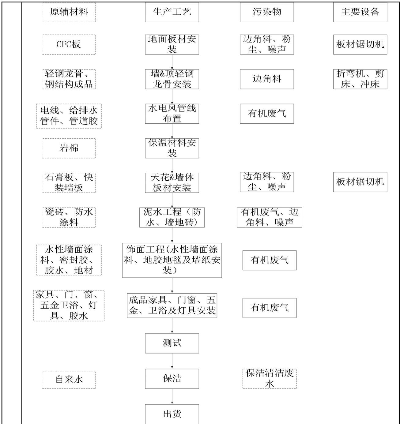
图 2-3 钢结构集成模块化建筑模块生产工艺流程
