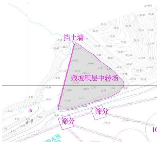
图 5-5 残坡积层中转场拦渣坝工程布置图
