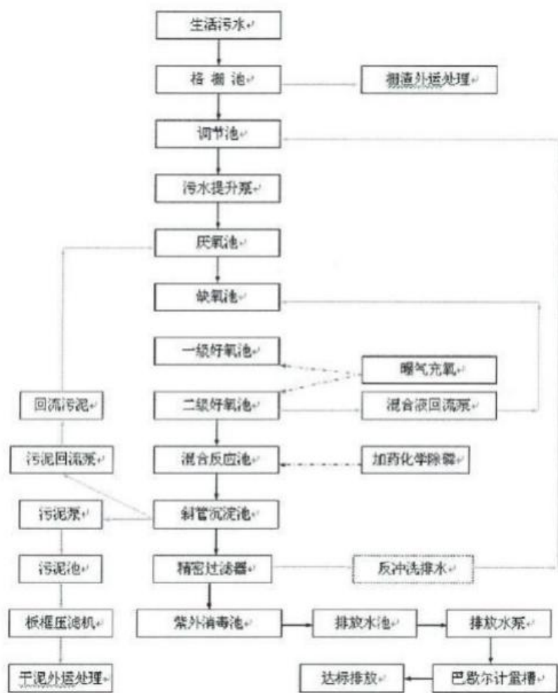
图 4-2 三江镇污水处理厂处理工艺流程图
