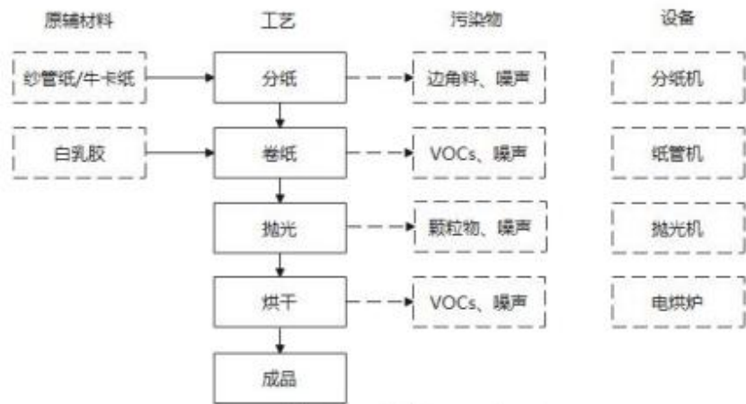
图 2-4 原有项目纸管项目生产工艺及产污流程图。
