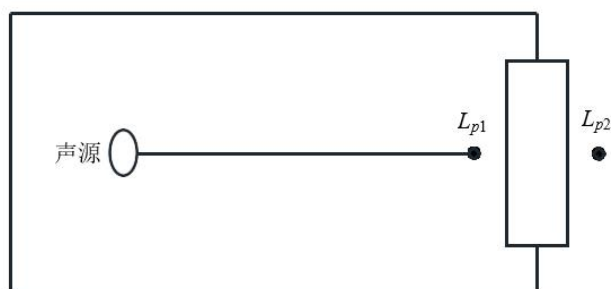
图 6.4-1 室内声源等效为室外声源图例
