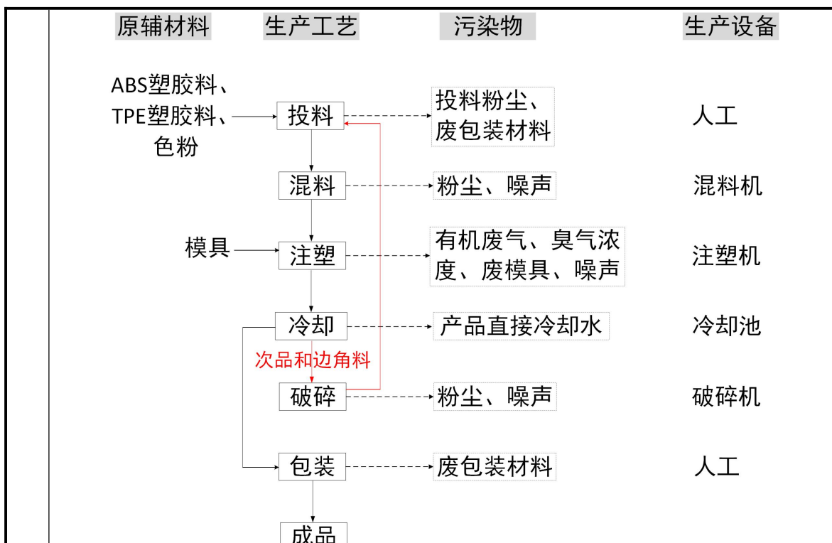
图 2 项目塑胶玩具一工艺流程图
