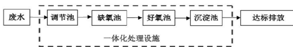
图3. 一体化污水处理设施处理工艺流程及产污环节
