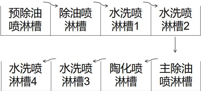
图 2-4.金属表面前处理工艺流程
