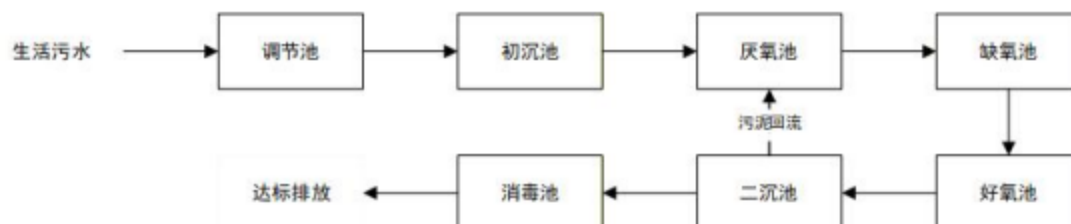
图 4-2 一体化污水处理设施工艺流程图
