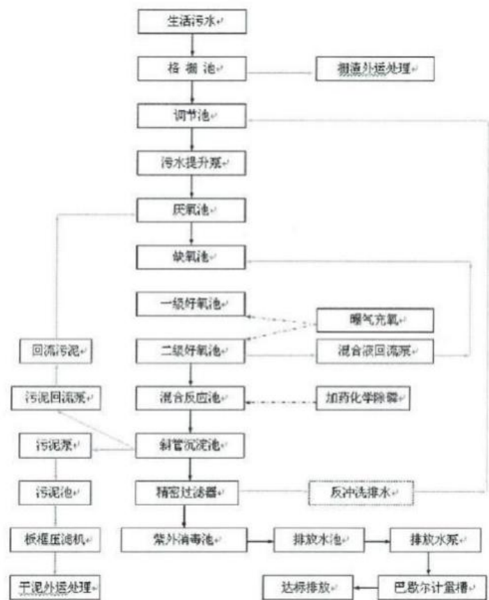
图 4-2 三江镇污水处理厂处理工艺流程图
