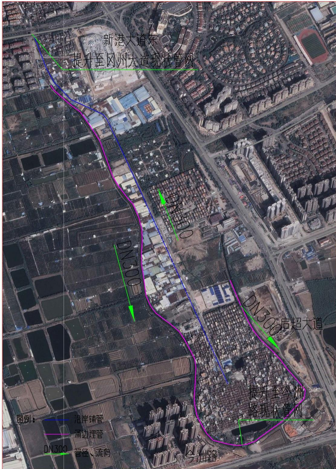
图 8.1-5 城南冲支流与梅江环河支流截污管网平面示意图
