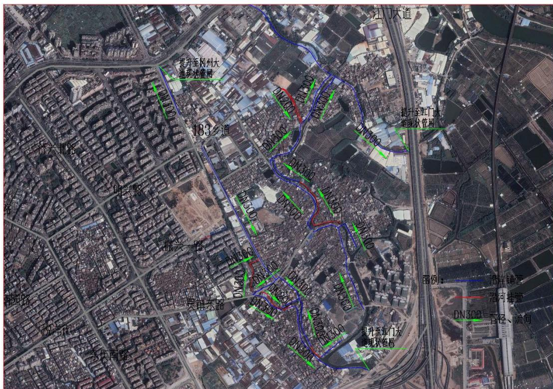
图 8.1-3 东甲河及东甲老围冲支流管网平面示意图
