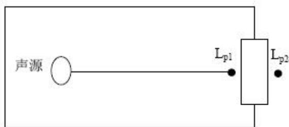
图 6.3-1 室内声源等效为室外声源图例
