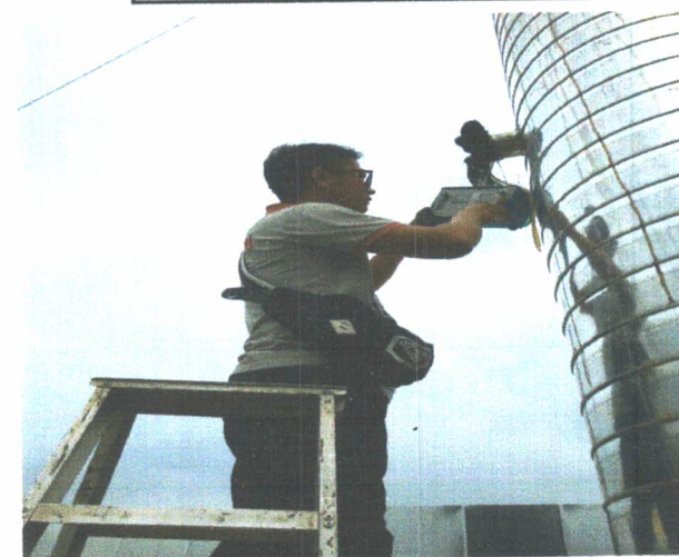
图 7 工艺废气排气筒采样口 (处理后)
