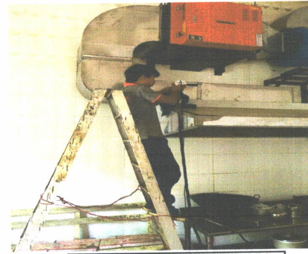
图 8 油烟废气排气筒采样口 (处理前)
